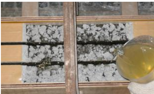
写真-3 検討方法 b 樹脂注入状況
