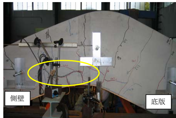
写真-2 Case2のひび割れ状況 ( \delta=2\delta y )
