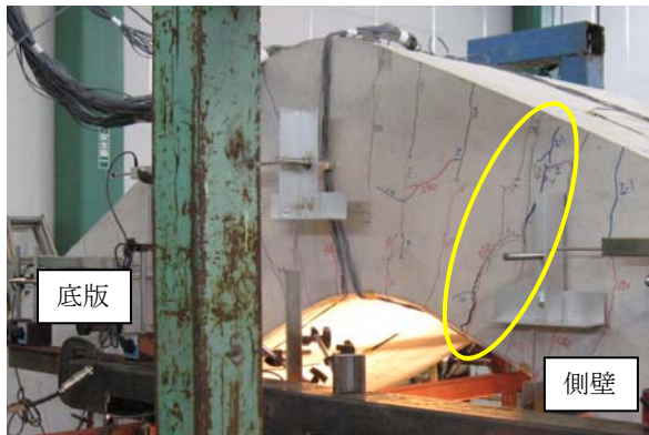
写真-1 Case1のひび割れ状況 ( \delta=2\delta y )
