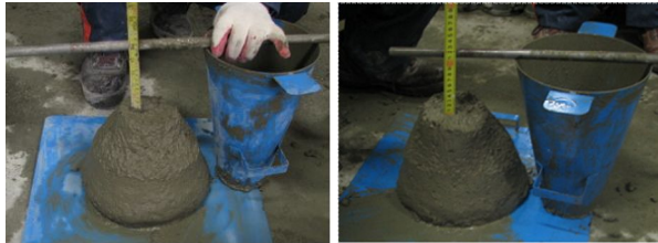
(c) PA 繊維混入試験体 (d) SF 繊維混入試験体
