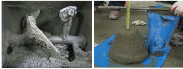
(a) コンクリートの練混ぜ (b) プレーン試験体
