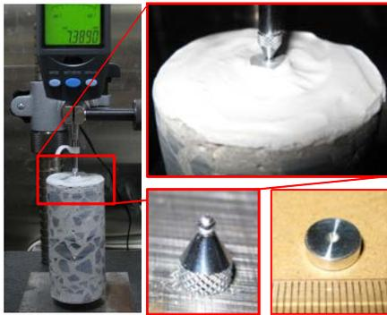
写真 - 1 長さ変化に用いたコア供試体および測定器
