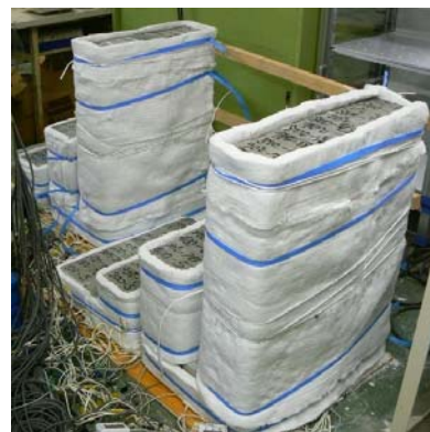
写真 - 1 片面加熱状況
