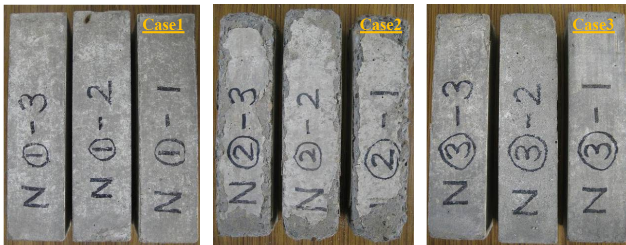
写真-4 410 サイクル終了時における供試体の状況
