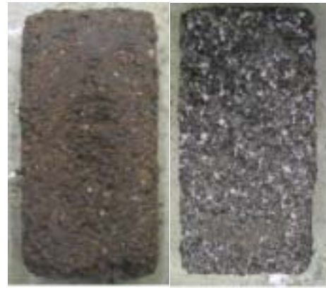
図-5 50 サイクル時における劣化状況 (左 N3, 右 W3)
