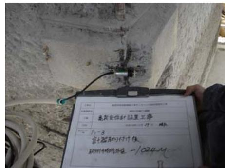
写真-4 亀裂変位計設置状況（A 橋）
