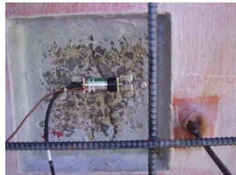
写真-5 亀裂変位計設置状況（C 橋）
