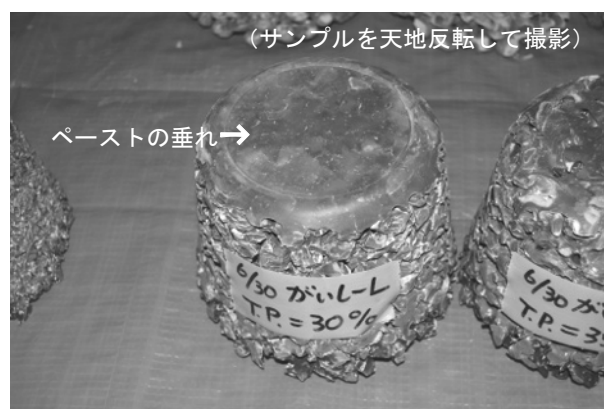
写真-2 セメントペーストの垂れ
