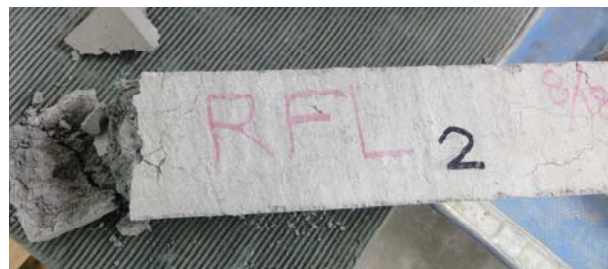
写真-1 凍結融解 180 サイクル終了後の RFL 供試体
