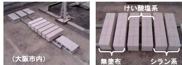
図-4 屋外曝露試験状況
