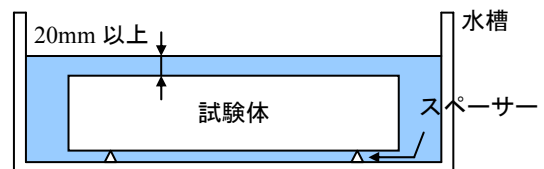
図-7 水中浸漬試験の概念図
