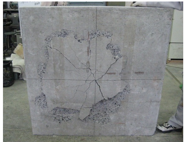
写真-4 補修床版の試験後（下面の状況）
