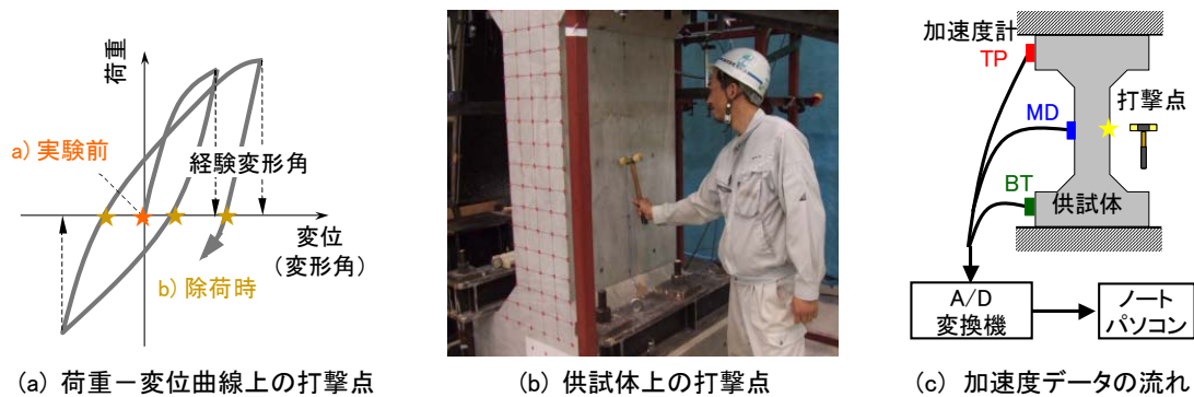
図-3 ハンマリングによる自由振動試験の概要
