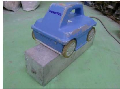
写真-1 電磁波による測定状況
