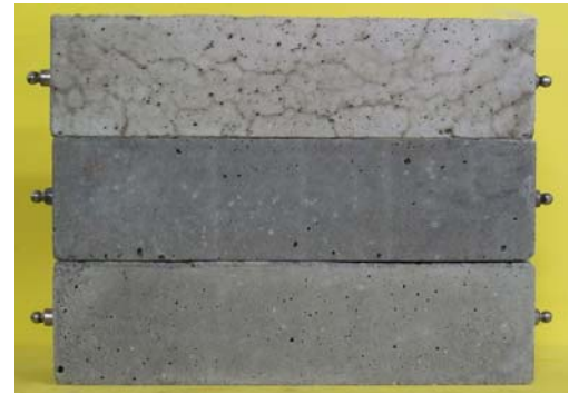
図-9 表面ひび割れの発生状況の比較 (上から OP, GP1, GP2)
