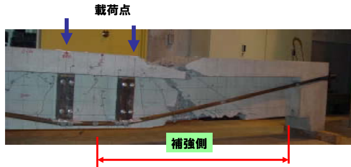
写真-2 No5 試験体の破壊状況
