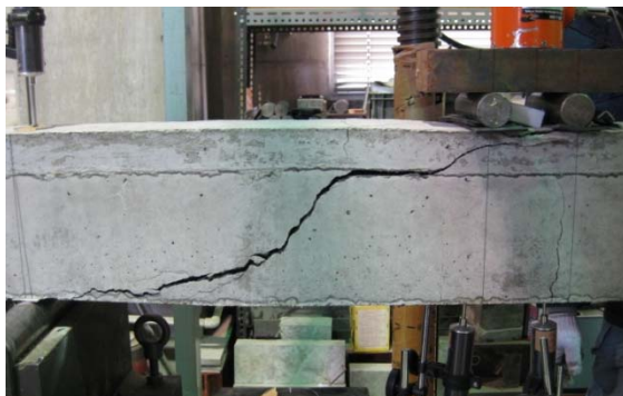
写真-3 試験体 B2 の終局状態
