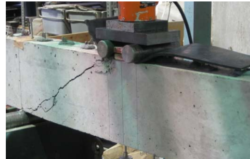
写真-2 試験体A4の終局状態 (微膨張型韧性モルタルによる全高補強)
