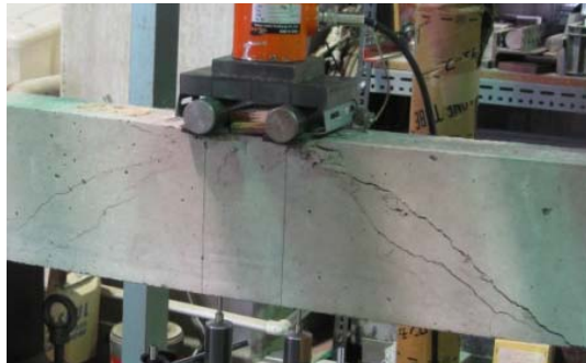
写真-1 試験体A2の終局状態 (標準スターラップ配置)
