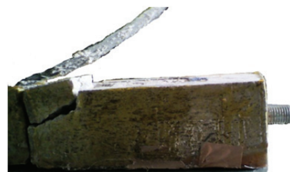
図-7 両引き付着試験でのBFRP剥離の様子(S-B2-P2)
