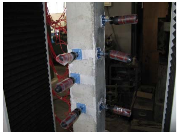
写真-1 ひび割れ補修状況（供試体 T03-R）
