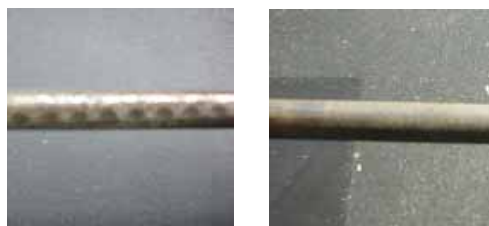
写真 - 1 使用鋼材 (左: 異形, 右: 丸鋼)
