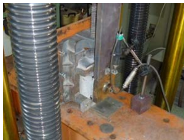
写真-2 せん断接着試験状況
