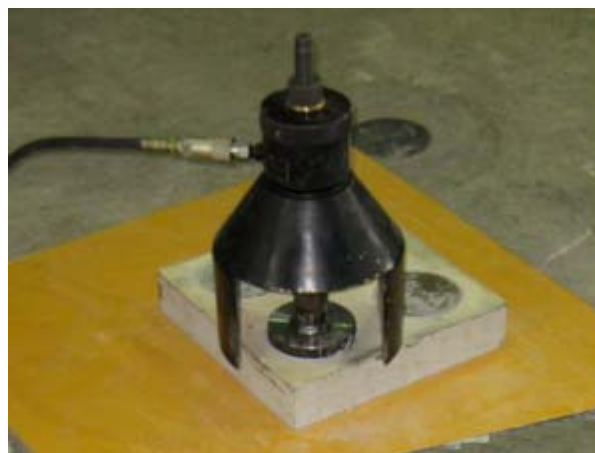
写真-1 引張接着試験状況
