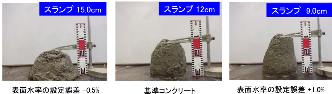
写真-1 細骨材表面水率の設定誤差を変えた場合のスランプ試験状況
