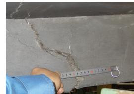
写真-4 最大変位時のひび割れ
