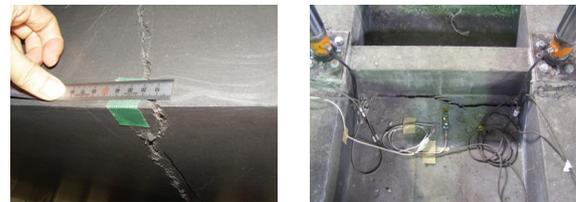
写真-2 最大耐力時のひび割れ
