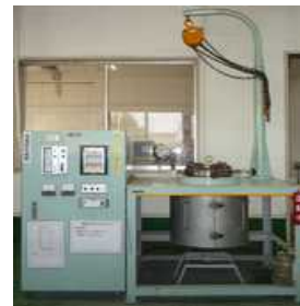
写真 - 4 オートクレーブ試験装置
