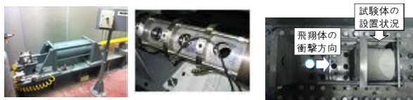
(b) 発射部 (c) 速度計測部 (d) 試験体チャンパー 図-4 高速飛翔体の衝突による耐衝撃性能試験装置
