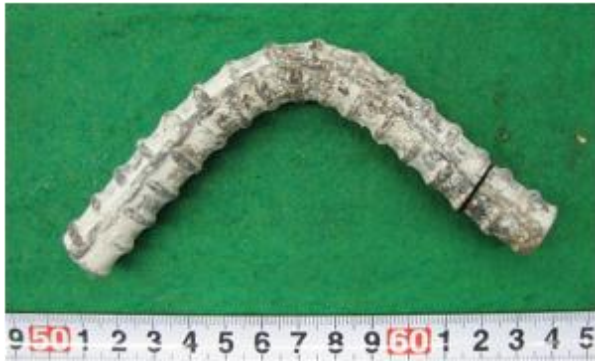
写真-7 曲げ半径測定に使用した鉄筋 (D16)
