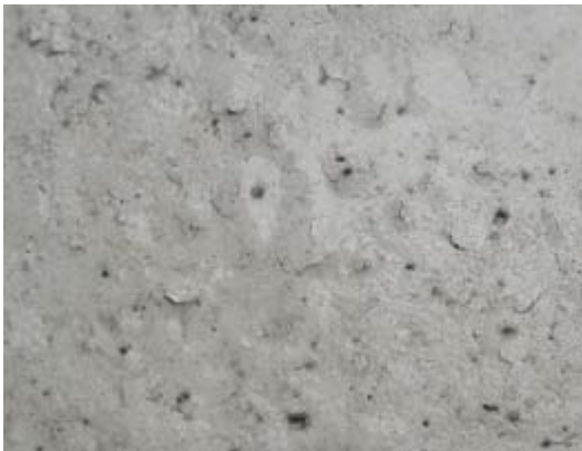
写真-2 合金 a 解体直前の皮膜表面状況
