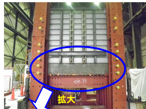
写真-1 打設状況 (型枠上昇)
