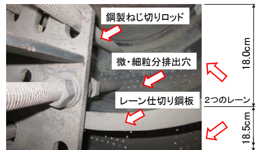
写真-2 試験用すりもみ装置内部の概要
