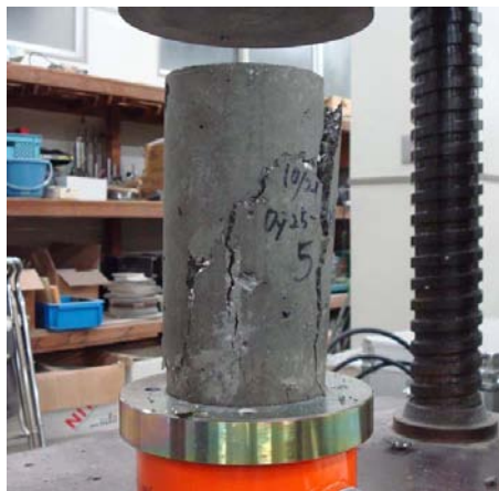
写真-5 牡蠣殻コンクリートの破壊状況 (Oy25-25)
