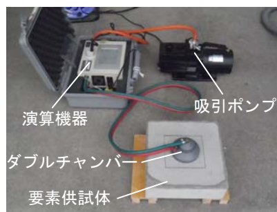
写真-1 Torrent 法に準拠した表層透気試験機
