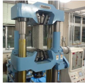
写真-1 万能試験機による重ね継手の両引き試験
