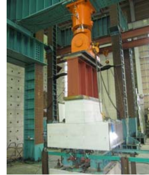
図-2 載荷試験の状況
