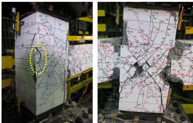
写真 - 1 試験体 BL の最終破壊状況
