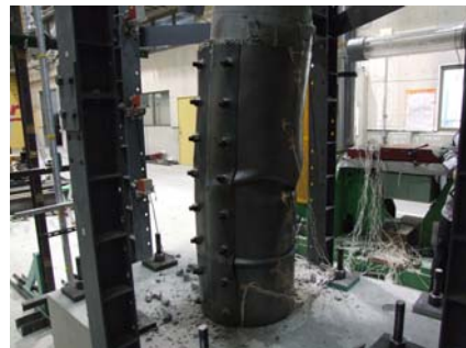
図-10 試験体 No.4 荷重-変位曲線 写真-7 鋼板座屈状況(60 終了時) 写真-8 鋼板座屈状況(245 終了時)
