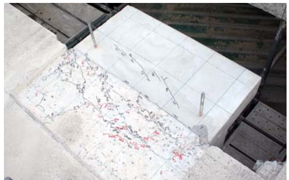
(b) 最終破壊状況 写真-4 破壊状況
