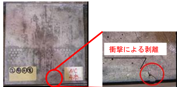
写真-6 衝撃試験後の剥離
