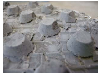
写真-3 最大荷重直後の凸部の状況 (No.4 試験体)
