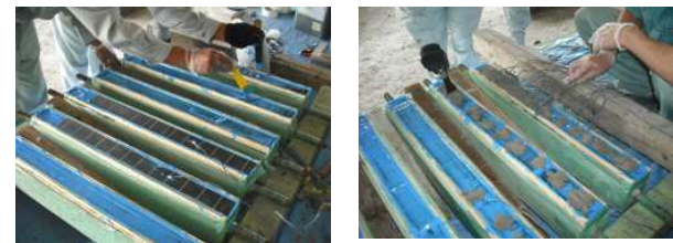
写真-3 試験体作成状況およびひずみゲージ設置位置(JCM)
