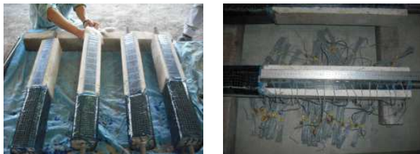
写真-2 試験体作成状況およびひずみゲージ設置位置(エポキシ樹脂)
