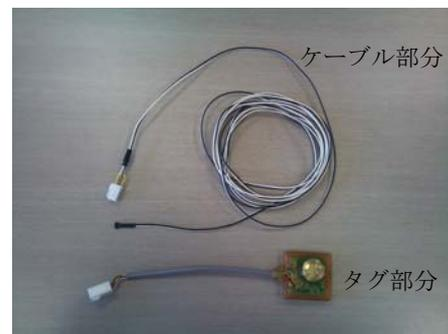
写真-1 計測センサーケーブル
