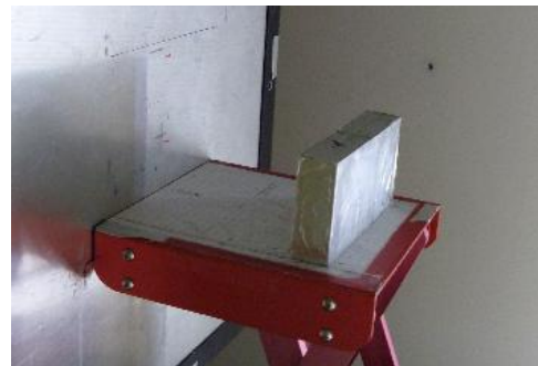
写真-1 照射台上に載せた供試体と中性子受光部
