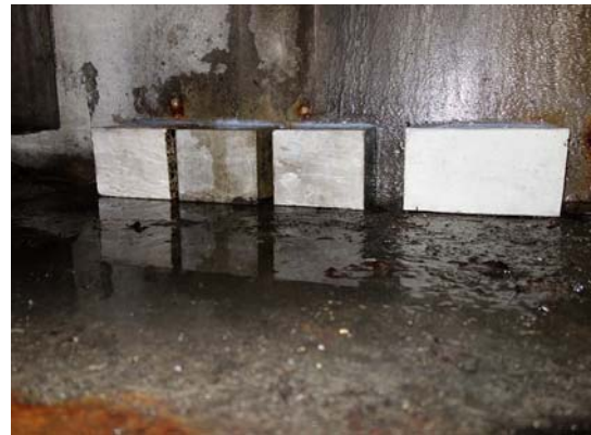
写真-2 M橋における曝露試験状況
