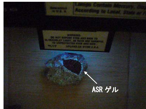
写真-14 破断面での適用例（UV灯下）
