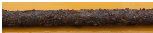
写真-2 試験片の腐食状況
