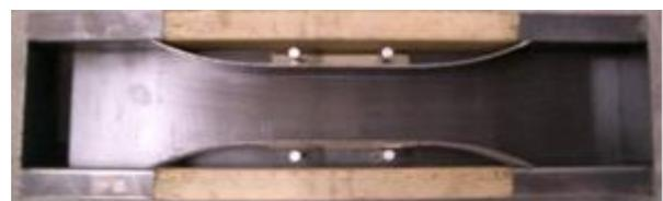
写真-2 一軸直接引張試験機
