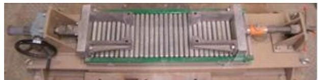
写真-1 一軸直接引張試験機
