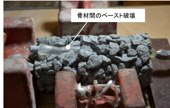
写真-3 ポーラスコンクリートの破壊状態
