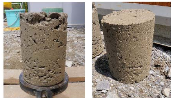
写真 - 3 S/A=36.7%のセメント混合物の性状
