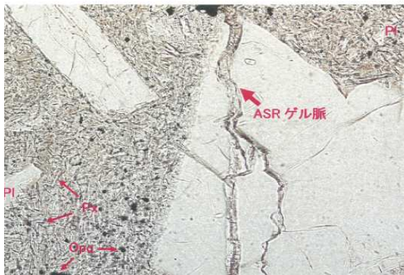
写真-2 骨材クラック状況
