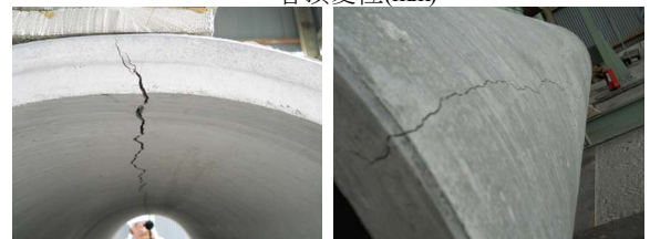
図-6 管の破壊試験結果
