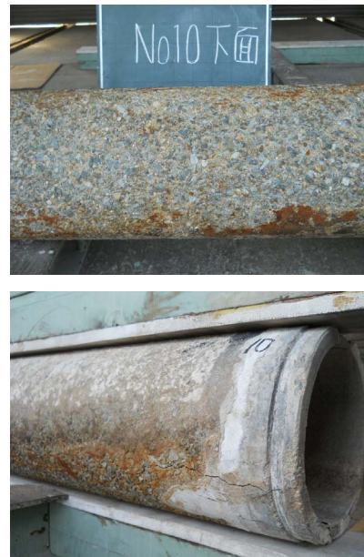
図-11 掘出し管の外観と破壊試験状況(φ250)
