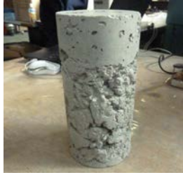
図-6 ジャンカ供試体のジャンカの程度
